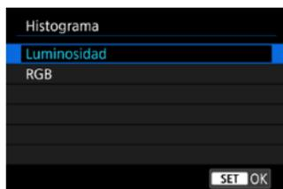
El histograma de brillo muestra la distribución de niveles de exposición y la luminosidad general. El histograma RGB sirve para comprobar la gradación y la saturación de color. Puede cambiar el histograma que se muestra presionando el botón <INFO> cuando se muestre <INFO> abajo a la izquierda de la pantalla [**▶**]: **Visualiz. info. reproducción**.
