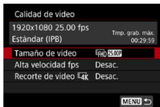
Bajo la ficha [📷: **Calidad de vídeo**], ajuste el tamaño de imagen, la frecuencia de fotogramas y el método de compresión. El vídeo se grabará como un archivo MP4. La frecuencia de fotogramas que se muestra en la pantalla [**Tamaño de vídeo**] cambia automáticamente en función del ajuste de [🔧: **Sistema vídeo**] (📖520).
