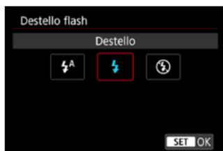
Ajuste [**⚡A**] (en los modos de la zona básica o <P>) para hacer que el flash dispare automáticamente, en función de las condiciones de disparo.
