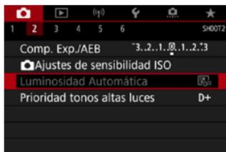
Los elementos de menú atenuados no se pueden ajustar. El elemento de menú aparece atenuado si hay otro ajuste de función que prevalezca sobre él.
