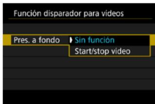
Con [**Pres. a fondo**] ajustado en [**Start/stop vídeo**], puede iniciar o detener la grabación de vídeos no solo con el botón de grabación de vídeo, sino también presionando hasta el fondo el disparador o utilizando el Control remoto RC-6, el Control remoto inalámbrico BR-E1 o el Disparador remoto RS-60E3.
